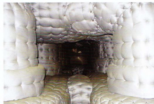
De Porsche met de door C.J. van Waas verzorgde uitlaatsisolatie die een snelheid van 417 km/u mogelijk maakte.
