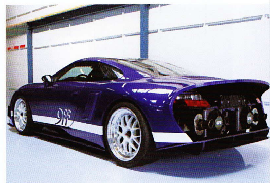
De Porsche met de door C.J. van Waas verzorgde uitlaatsisolatie die een snelheid van 417 km/u mogelijk maakte.
